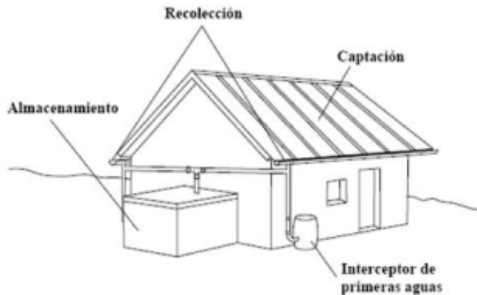
Figura 8. Sistema básico de captación de aguas lluvias Fuente: Guía de Diseño para Captación de Agua de Lluvia. CEPIS, 2004.
