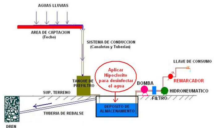
Figura 16. Diseño Esquemático de Reciclaje de Aguas Lluvias para Riego de Jardín, Lavado de Autos, WC, Lavado de Ropas y Consumo Humano con sus componentes necesarios
