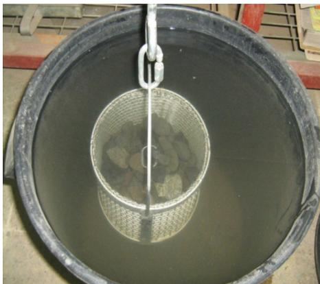
Fig. 5.- Determinación de densidades (Fuente: Serrano 2010)
