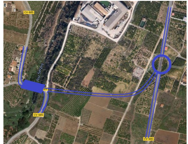
Figura 5 Alternativa 1; Mejora del trazado del último tramo de la CV-685 (eliminación del garrote y ampliación de la anchura del puente) y creación de un nuevo eje de conexión con la CV-680 por fuera de la población
