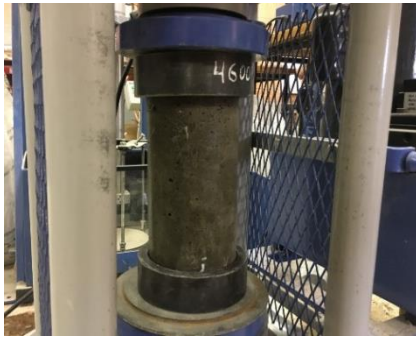
Figura 1. Ensayo de resistencia a la compresión en una de las muestras cilíndricas de la mezcla de concreto alternativa
