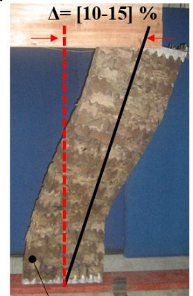
Fluencia del refuerzo longitudinal en la base del panel
