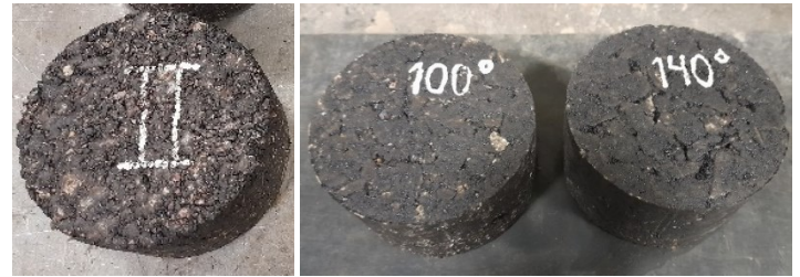
Figura 5. Probetas moldeadas con el pastón de pruebas del Grupo 1 (a) y del Grupo 2 y 3 (b) (fuente: elaboración propia).
