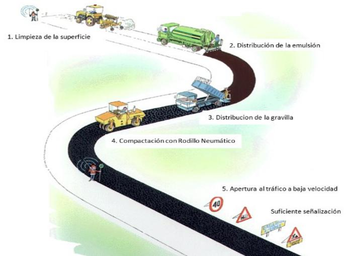
Figura 2. Etapas o pasos que deben seguirse para la colocación de un riego de sello con gravilla.
