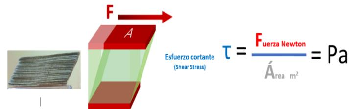
Figura 4. Explicación del esfuerzo cortante (Shear Stress) aplicado a el asfalto.
