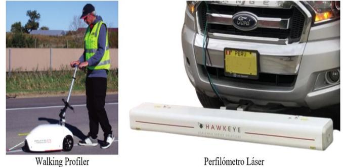
Figura 1. Equipos para evaluación de perfiles longitudinales (Fuente: ARRB Brochures).
