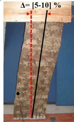
Endurecimiento por deformación debido a fuerzas de contacto
